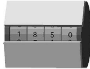
الشكل 2.12 نتيجة قياس مسافة تساوي 1850 قدماً.
